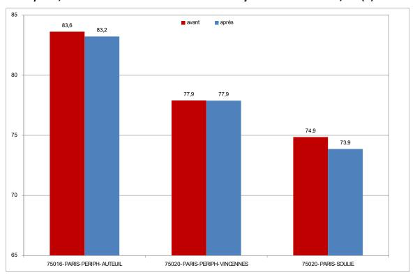
Comparaison des niveaux de bruit diurnes (LAeq 6-22h) exprimés en dB(A) sur les stations du périphérique avant et après l'entrée en vigueur de la baisse de la vitesse limite
