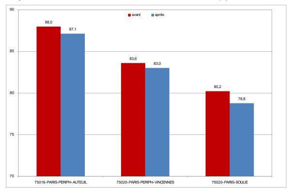
Comparaison des niveaux de bruit selon l'indicateur Lden, exprimés en dB(A) sur les stations du périphérique avant et après l'entrée en vigueur de la baisse de la vitesse limite
